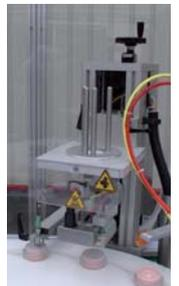
Notre ligne modulaire répond à ces exigences : la définition de la ligne à la carte permet de démarrer avec un module de dosage + thermoscellage pour s'équiper ultérieurement de modules complémentaires. Les changements de formats sont simples pour permettre plus de flexibilité face aux petites séries et la cadence de 20-25 opérations/min permet de travailler sereinement sur des séries plus importantes.
