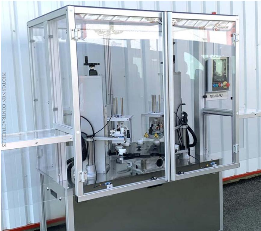
Ces machines sont étudiées pour le thermoscellage automatique d'opercules pré-découpés sur tous types d'emballage rigides plastiques ou verre (traités pour le scellage idéalement) et sont destinées à s'insérer sur le convoyeur principal de votre ligne de conditionnement. Elles sont dotées de postes de scellage TCE260A, grand standard d'EMBATHERM, qui assurent en une seule opération la prise, la dépose et le thermoscellage de l'opercule.
